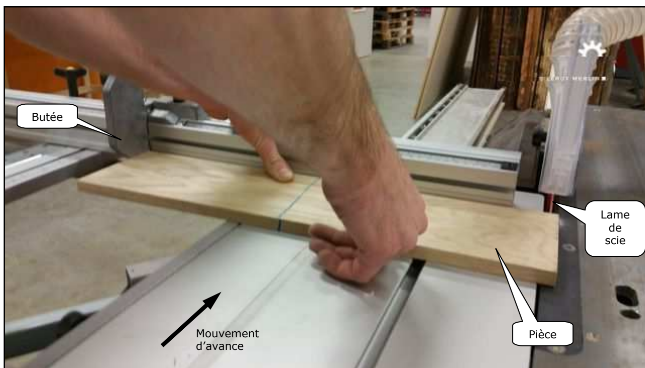
Figure 1 : Exemple de situation où le positionnement d'une pièce est nécessaire.
